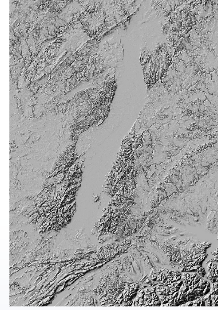
Modèle Numérique de Terrain (MNT): extrait des données SRTM V2 de la NASA. Il permet une représentation uniforme de la topographie.
